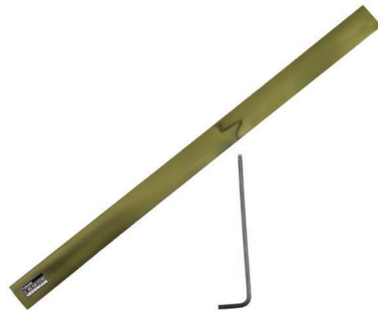
Sichtbare Markierung auf Prüffolie nach Berührung mit Inbusschlüssel als Indikator für Magnetisierung des Werkzeugs
